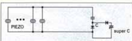
Fig. 3: Circuit à convertisseur à transfert de charge
